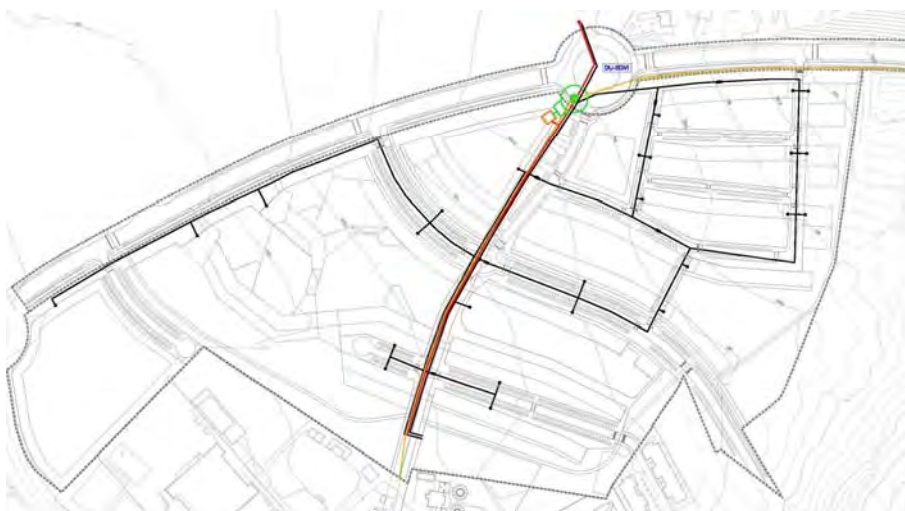
Esquema indicativo de red de frío-calor con solución de District Heating
